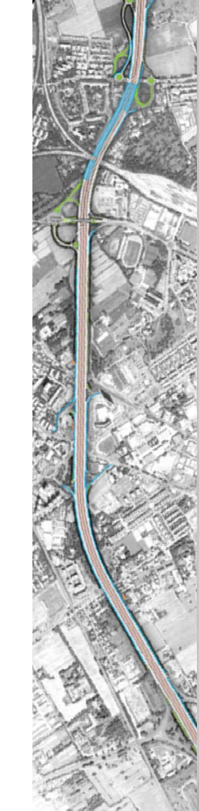
Nel Progetto Preliminare, “Relazione Preliminare”, pag. 24, si prevedono corsie di 3,50 m (3 per autostrada e 3 per tangenziale per senso di marcia), corsie di emergenza di 3,00 m, margine interno di 3,20 m, spartitraffico autostrada/tangenziale di 1,60 m; quindi la larghezza complessiva della piattaforma pavimentata stradale risulta :  $(3,50 \times 3 + 3,00 + 3,50 \times 3 + 3,00 + 3,20/2 + 1,60) \times 2 = 60,40$  m.
