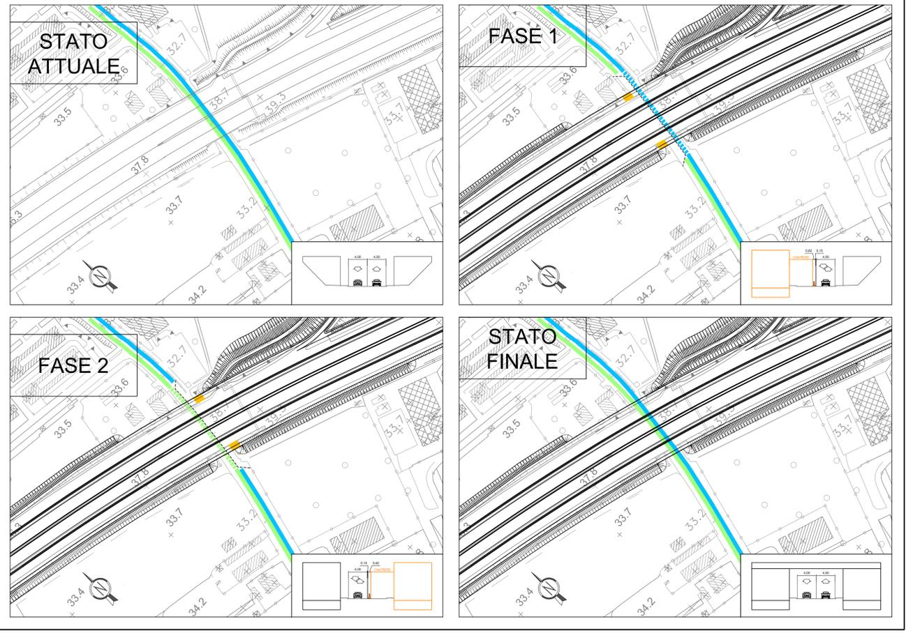
IL TRAFFICO AUTOSTRADALE DURANTE LA REALIZZAZIONE DEI SOTTOVIA SARA' CONFIGURATO COME RAPPRESENTATO NELLA SOTTOSTANTE SEZIONE. IN PLANIMETRIA IL TRAFFICO AUTOSTRADALE NON E' STATO VOLUTAMENTE RAPPRESENTATO PER DARE EVIDENZA ALLE FASI DEI LAVORI E DEL TRAFFICO STRADALE RELATIVI AI SOTTOVIA
